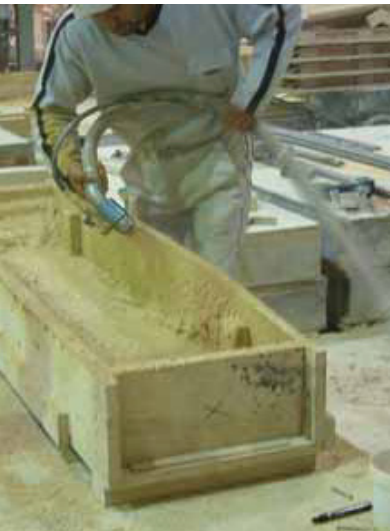
Şekil 1: Püskürtmeli ön karışım yönteminde karıştırma işlemi sırasında matrise elyaf eklenir ve karıştırılan elyaf ile matris önce bir püskürtme tabancasına oradan da kalıbın üzerine püskürtülür.
