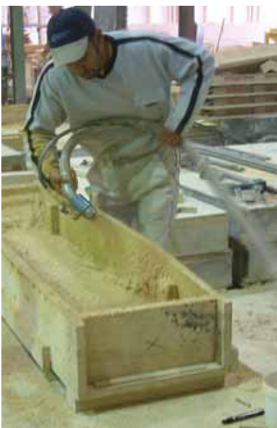
Figura 1: En la premezcla para rociado con pulverizador, las fibras se añaden al mortero durante el proceso de mezclado y, una vez mezcladas las fibras con el mortero, se introducen por bombeo en un pulverizador y se rocían en el interior del molde.
