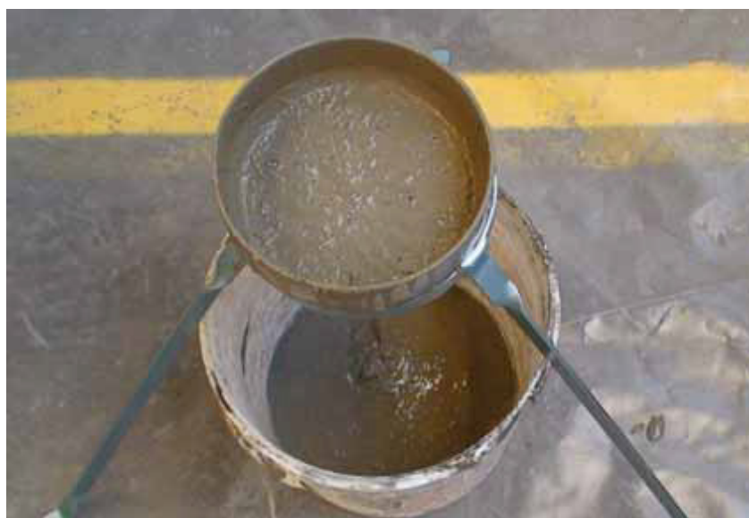
Figura 1: Aparato para medir la fluidez
